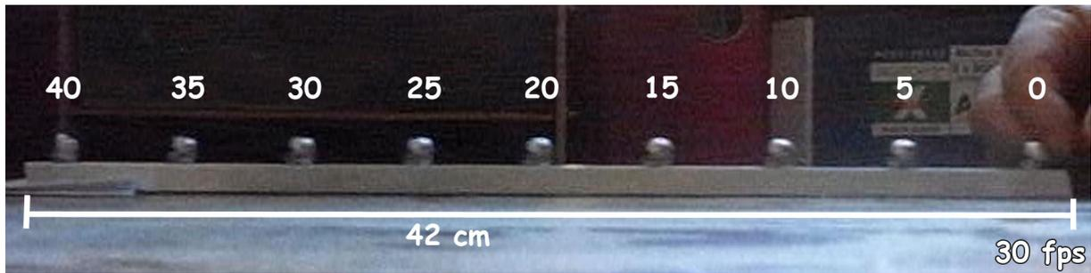
Abbildung 1.1: Überlagerung des Bewegungsablaufs einer rollenden Kugel. Die Zahlen über den Kugeln geben die Bildnummer an. Es wurden 30 Bilder pro Sekunde gemacht. Die Bahnlänge betrug 42 cm.
