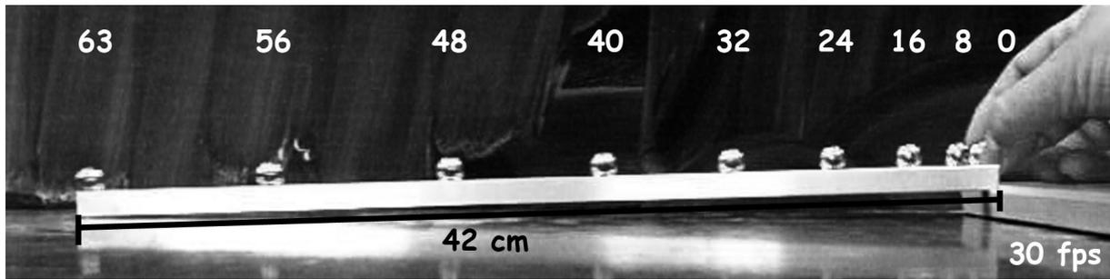
Abbildung 3.1: Überlagerung des Bewegungsablaufs einer abwärtsrollenden Kugel. Die Zahlen über den Kugeln geben die Bildnummer an. Es wurden 30 Bilder pro Sekunde gemacht. Die Bahnlänge betrug 42 cm.
